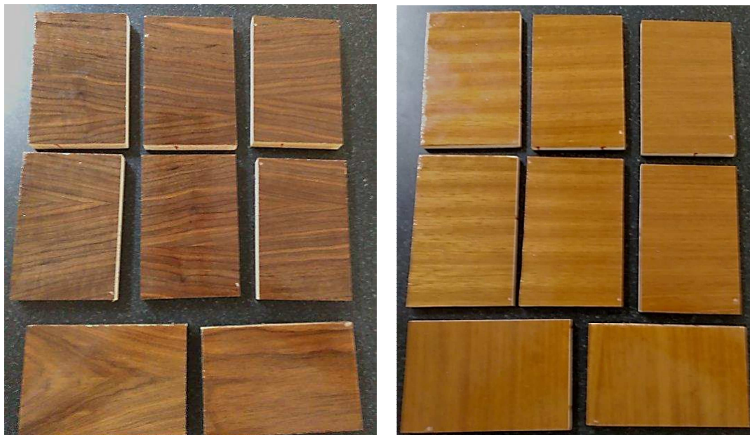
Figura 30. Aplicaciones de la formulación VV-204 sobre nogal y sobre iroko.
