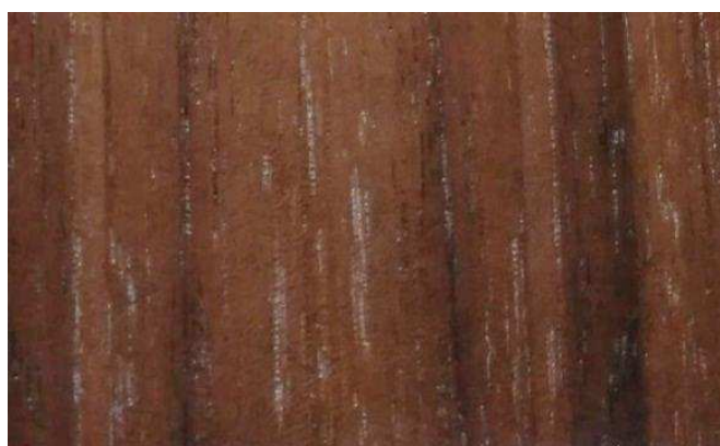
Figura 27. Blanqueamiento de poro en VV- 201 (1k)/Nogal. Replica 4.
